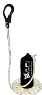
Ref: ELV-CP2-13 Línea de Vida Vertical elaborada en cuerda poliéster de 13mm con gancho recubierto en Nylon de 2 1/2" con contrapeso.
