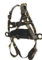
Ref: PAH-DLP-K2 Arnés de cuerpo entero Premium fabricado en resaca de Kevlar de 45mm de ancho con faja para apoyo lumbar y 4 argollas de D recubiertas con aislamiento dieléctrico. talla universal. modelo en H, incluye porta eslinga.
