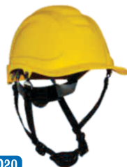
SAMURAI Casco de seguridad dieléctrico Tipo I clase E, G, con 4 puntos de conexión para barbuquejo, tipo safari (Ala ancha) para brindar mayor protección contra el sol. Ref: CA-P-D21
